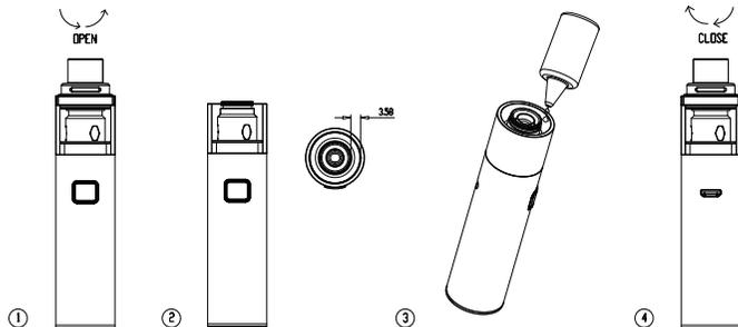
4. Zerstäuber wechseln: Schrauben Sie den Behälter von der Basis ab, um einen neuen Zerstäuber zu entfernen und einzustecken. Ziehen Sie den EUC aus der Basis und stecken Sie einen neuen ein.
