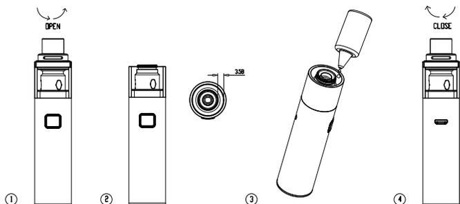
4. Verdampers vervangen: Schroef de tank van de basis om een verdampers(coil) te verwijderen en/of te vervangen door een nieuwe. Haal de EUC uit van de basis en zet er een nieuwe in.
