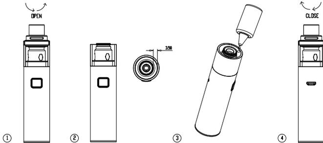
4. Evaporateur remplacé: dévisser le réservoir à partir de la base afin d'éliminer un évaporateur (bobine) et / ou de le remplacer par un nouveau. Retirez le EUC de la base et de mettre un nouveau.
