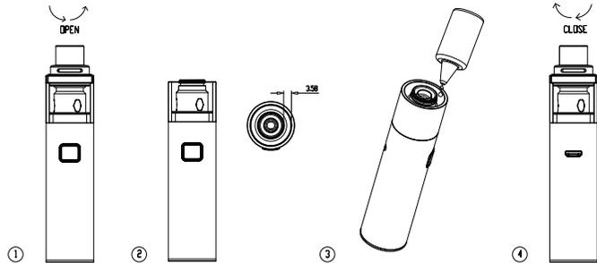
4. Reemplazo del atomizador: Desatorille el tanque desde la base para retirarlo e inserte un nuevo atomizador. Tire la EUC fuera de la base e inserte una nueva.
