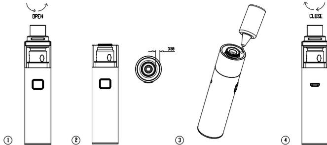
4. Skiftende Forstøver: Skru beholderen fra basen for at fjerne og indsætte en ny forstøver. Træk EUS ud fra basen og isæt en ny. Skru på Basen. Vent efter udskiftning for at sikre, at spolen er godt spædet.
